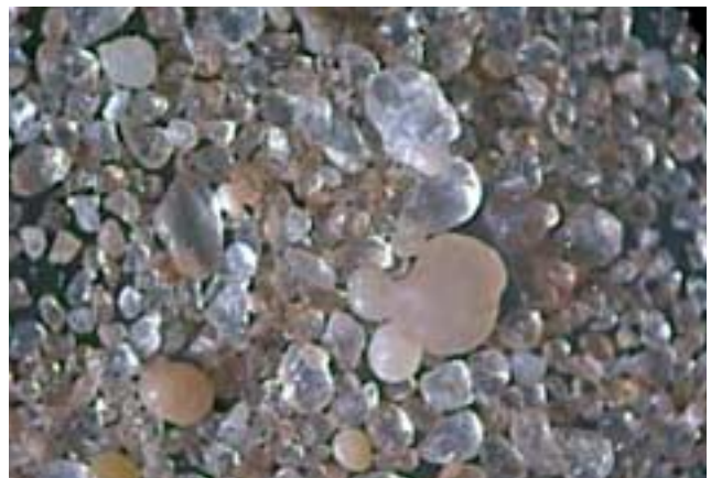
Bild 16: Kubische Sandkornzusammensetzung eines Natur-sandes
